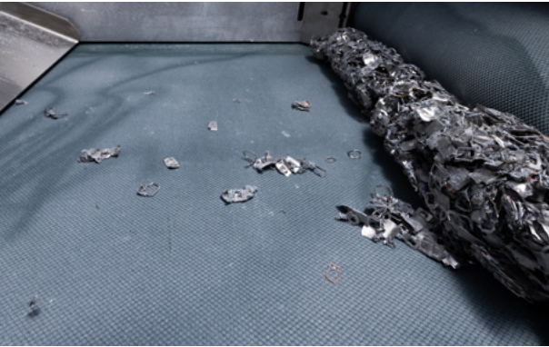
Taz 的“雪球”净化器从磁铁和钢中去除塑料碎片
